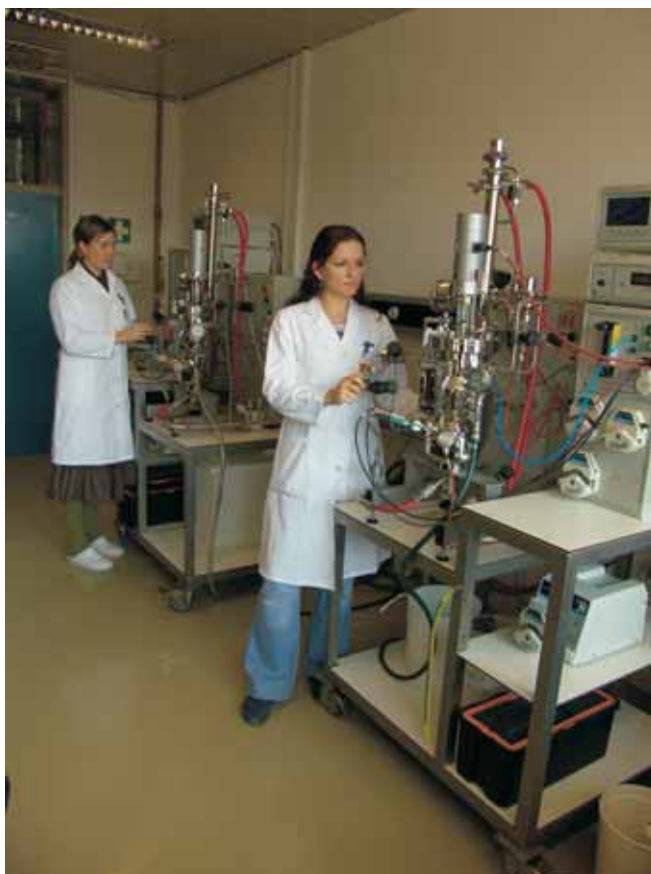
SLIKA 3: Fermentacijski laboratorij na Kemijskem inštitutu - z bioreaktorji za pridobivanje rekombinantnih proteinov v mikroorganizmih
