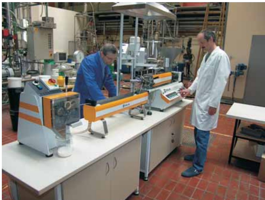
SLIKA 1: Dvopolžni ekstruder Teach-Line ZK 25T z vodno kopeljo in granulatorjem, Dr. Collin.
