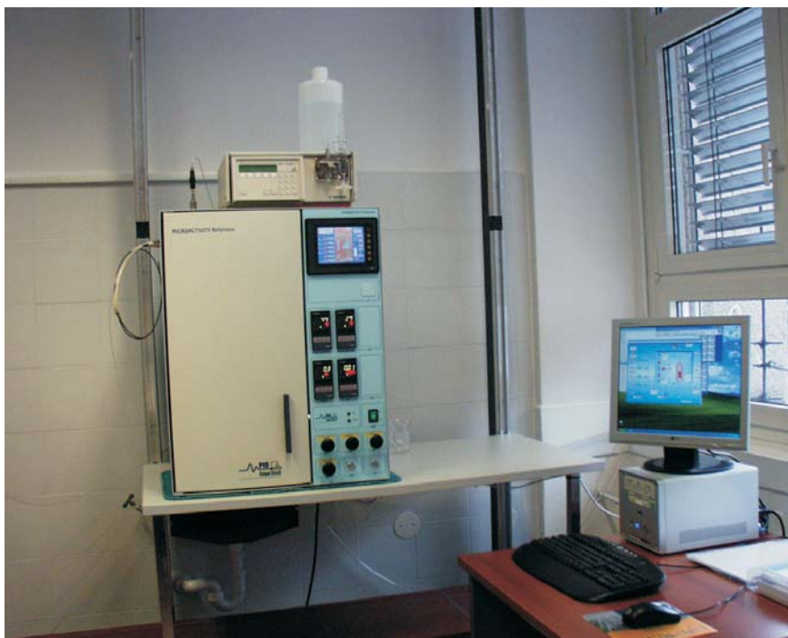
SLIKA: Računalniško vodeni kontinuirni reaktorski sistem »Microactivity Reference« za študij dvo- in trifaznih katalitskih reakcij pri temperaturah do 750 stopinj Celzija in tlakih do 100 bar (PID Eng&Tech, Španija)
