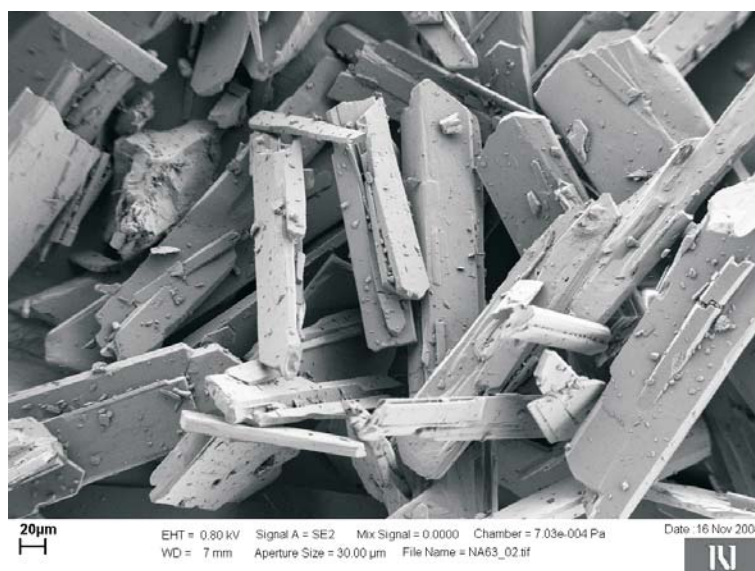
SLIKA 1: Morfologija naproksena, prekristaliziranega po običajnem postopku. Tipične dimenzije delcev: 20–100 mikrometrov.
