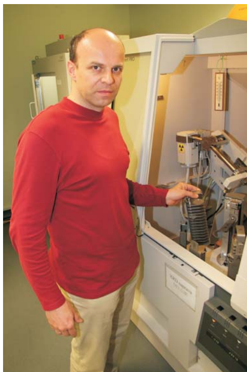
SLIKA 3: Edi Kranjc med meritvami na rentgenskem praškovnem difraktometru za identifikacijo in določanje strukture praškastih vzorcev
