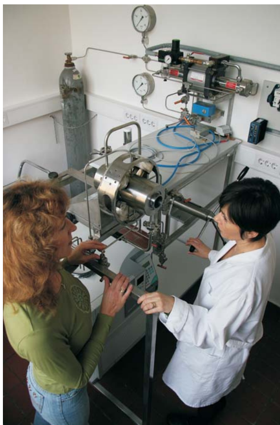
SLIKA 1: Gradnja naprave za določanje faznih ravnotežij pri visokih tlakih.
