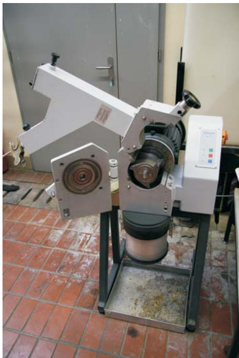
SLIKA 2: Kombinacija naprav za pripravo testnih vzorcev biomase in mešanih odpadkov: a) rezilni mlin, b) ultracentrifugalni mlin.
