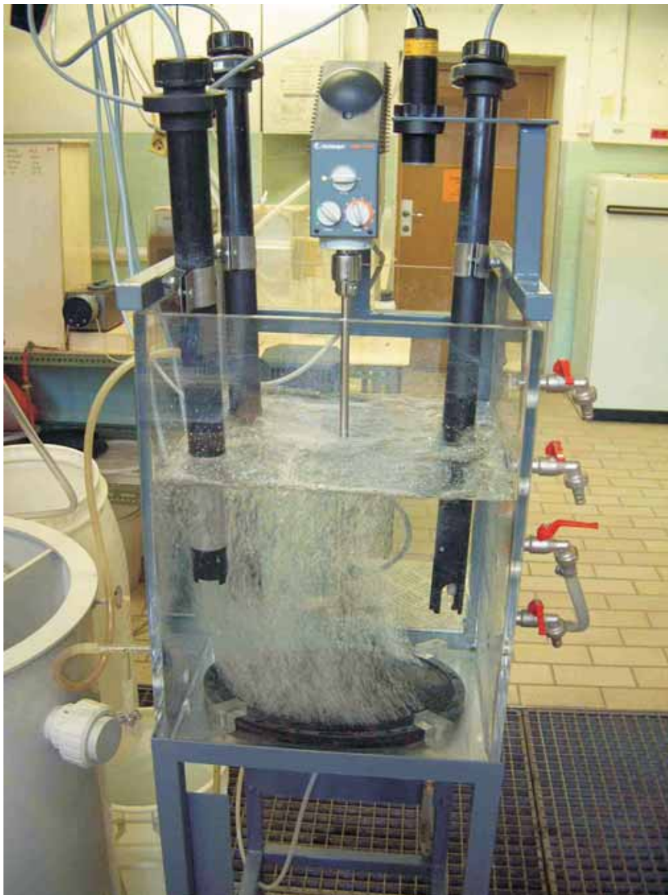
SLIKA 1 Šaržni biološki reaktor - preskus delovanja osnovnih delov laboratorijskega modela
