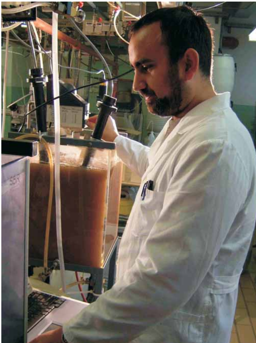
SLIKA 3 Šaržni biološki reaktor - raziskave z realno odpadno vodo
